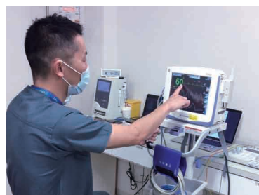
ベッドサイドモニタの定期点検。
